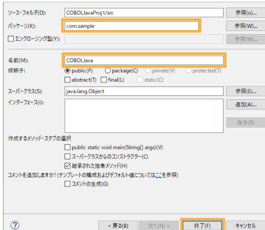
COBOLJavaProj1 プロジェクト配下に src¥com¥sample フォルダが作成され、COBOLJava.java が作成されます。
