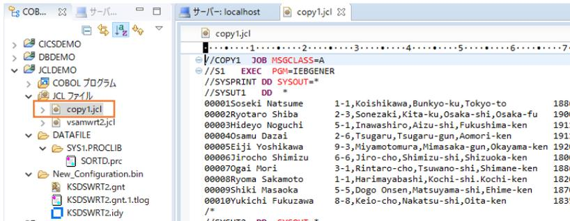
3.10.2 COBOL エクスプローラー内の copy1.jcl を右クリックして [Enterprise Server へのサブミット] を選択すると、この JCL が実行されます。
