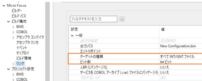
3.5.3 左側ツリービューの [Micro Focus] > [プロジェクト設定] > [COBOL] を選択して、下記項目を指定します。指定後は [適用して閉じる] ボタンをクリックしてください。
