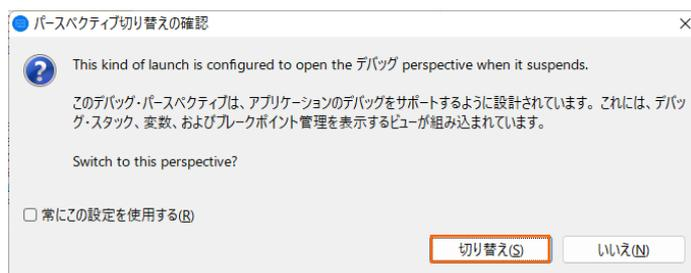
3.13.8 少し待つとデバッグセッションが開始して、プログラムのステップ実行が可能になります。[F5] キーもしくは [実行] プルダウンメニューから [ステップイン] を選択してステップを進めることができ、変数タブでは使用している変数の値が確認できます。
