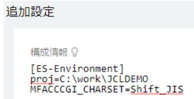
3.8.9 画面上部の [JES] プルダウンメニューから [構成] を選択し、表示される画面の各項目を設定します。構成情報に指定した proj 環境変数を使用して値を入力後、[適用] ボタンをクリックします。
