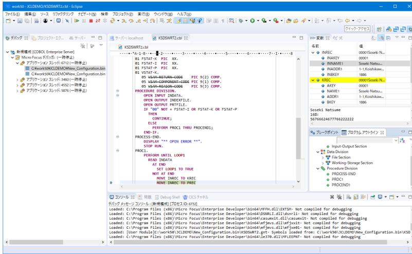
3.13.9 希望のステップの左端をダブルクリックすることにより、ブレークポイントを設定することも可能です。
