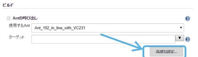
[ターゲット] 欄には `-lib <Visual COBOL のインストールフォルダ>\bin\mfAnt.jar` を、[ビルドファイル] 欄には Eclipse プロジェクトフォルダ配下にある Ant のビルドファイルを指定:
