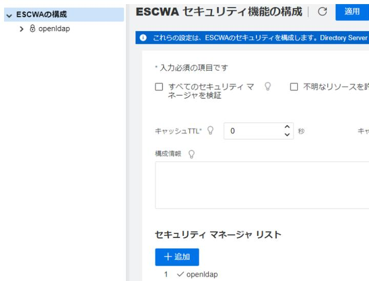
左側メニューの [openldap] をクリックすると、Linux9 環境で構築した OpenLDAP のリソースが表示されます。これにより ESCWA 上でリソースのメンテナンスが可能になります。
