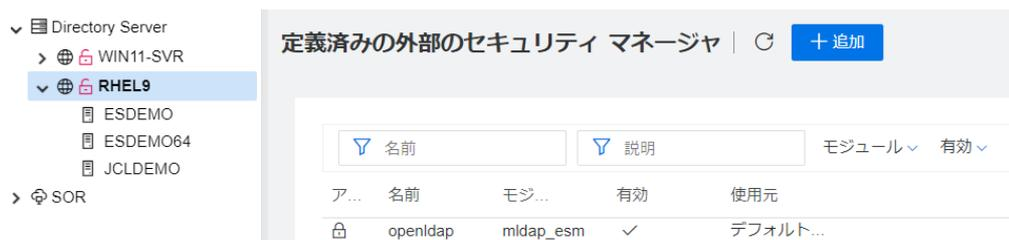
MFDS の [セキュリティ] メニューから [デフォルトの ES 構成] を選択し、[追加] ボタンをクリックします。ESCWA と同様に [openldap] にチェックして [選択] ボタンをクリックすると、[openldap] がリストに表示されますので、画面上部の [適用] ボタンで変更を保存します。
